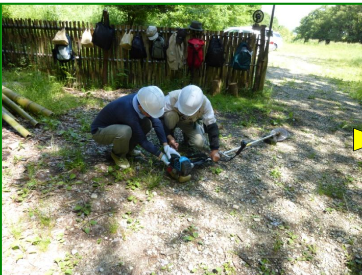
刈払機のエンジンが掛かりにくかったので、フィルター部を分解して清掃しました。長期間使用しないとこんな事もあります。
