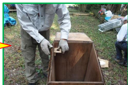
先に固定枠を止め、プレ止めをセット。
