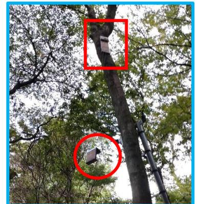
赤丸がカメラを取り付けたリフト。赤角がキャッチャ。蟻引き糸で引き上げます。
