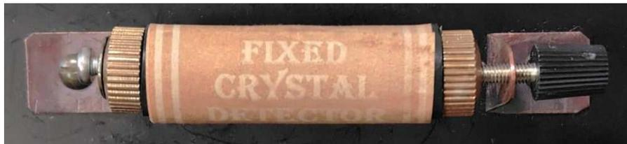
内部にゲルマダイオード 1N60 を収納して性能を確保することとし、外観は、エージング処理した紙にプリンタで印刷した紙を巻いて化粧した。プリンタ用紙はコーヒーを用いてエージングした。ローレットネジはコンロで加熱してエージングした。
