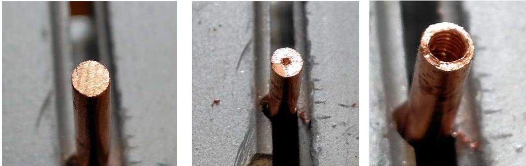
これを10mm長に切断し、頂部を丸く加工した。さらに、銅の光沢をなくしてアンティーク感を出す目的で、台所のガスコンロで焼いてエージング処理した。写真のように良い色に仕上がった。これをパネル裏からM2.6のネジで固定した。
