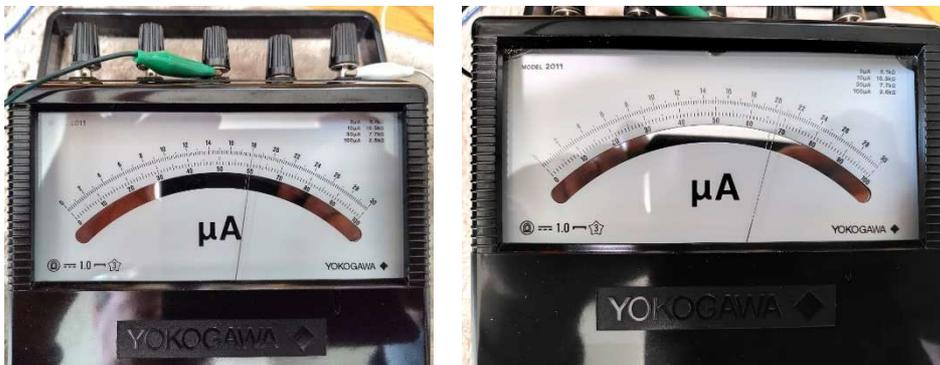
FS は  $30\mu\text{A}$  でこの時の内部抵抗は  $7.7\text{k}\Omega$  であるから、電流計の両端に  $0.15\text{V}$  程度の電圧を生じていることになる。パワーはざっと 3 マイクロワット。
